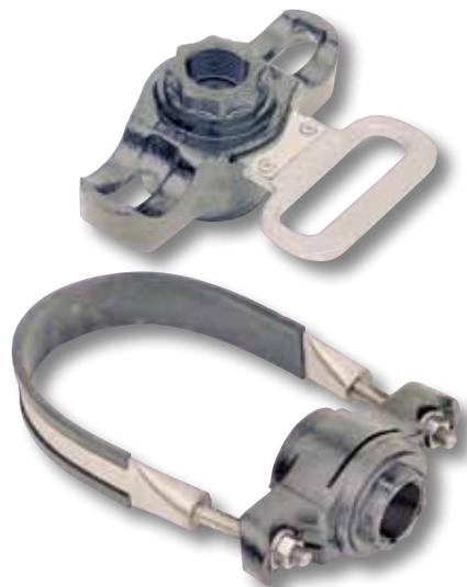
Конструкция седелки аналогична серии 1400, дополненная запорным элементом из нержавеющей стали AISI-304 шестигранной редукционной гайкой для врезки в трубу под давлением.
