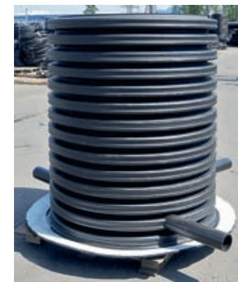
Фото 10. Сварная инспекционная камера
