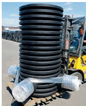
Фото 9. Сварной безлотковый тройниковый колодец
