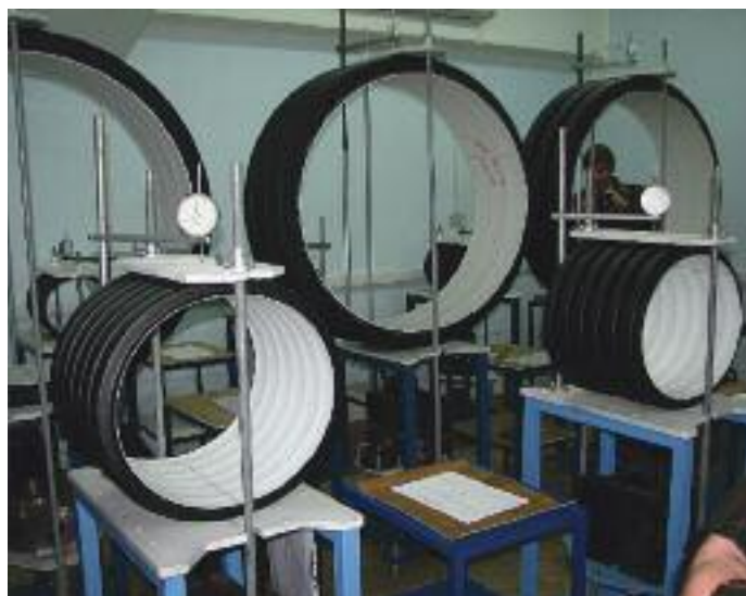
Рис. 6. Испытания по определению коэффициента ползучести
