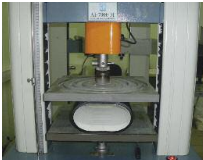
Рис. 5. Испытания на кольцевую гибкость
