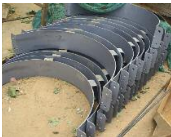
Рис. 21. Бандаж для ввода трубы Корсис 1000 мм в 1200 ж/б трубопровод.
